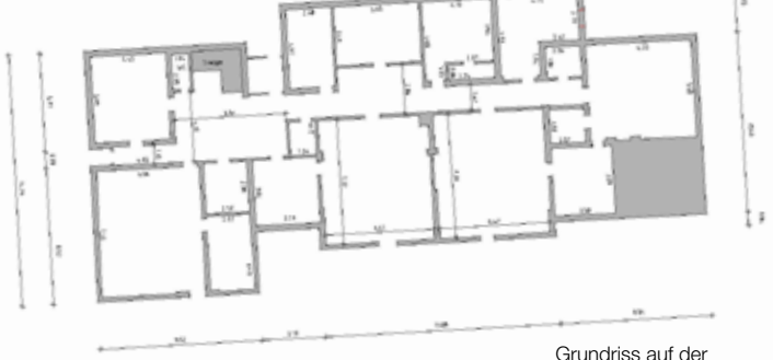
Grundriss auf der Basis einer Punktwolke
